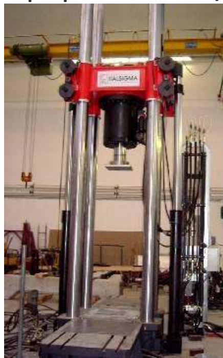
Macchina universale Altezza: da 0,4 a 4,2 m; Controllo spostamenti: +/- 75 mm Contr. forze: 3000 kN (comp)/2400 kN (traz)
