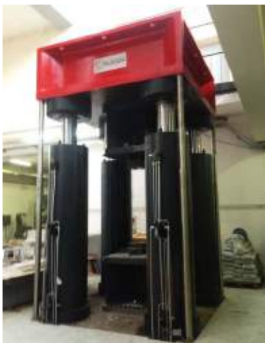
Macchina universale Altezza: da 1,5 a 4,8 m; Controllo spostamenti: +/- 125 mm Contr. forze: 30000 kN (comp)/20000 kN (traz)
